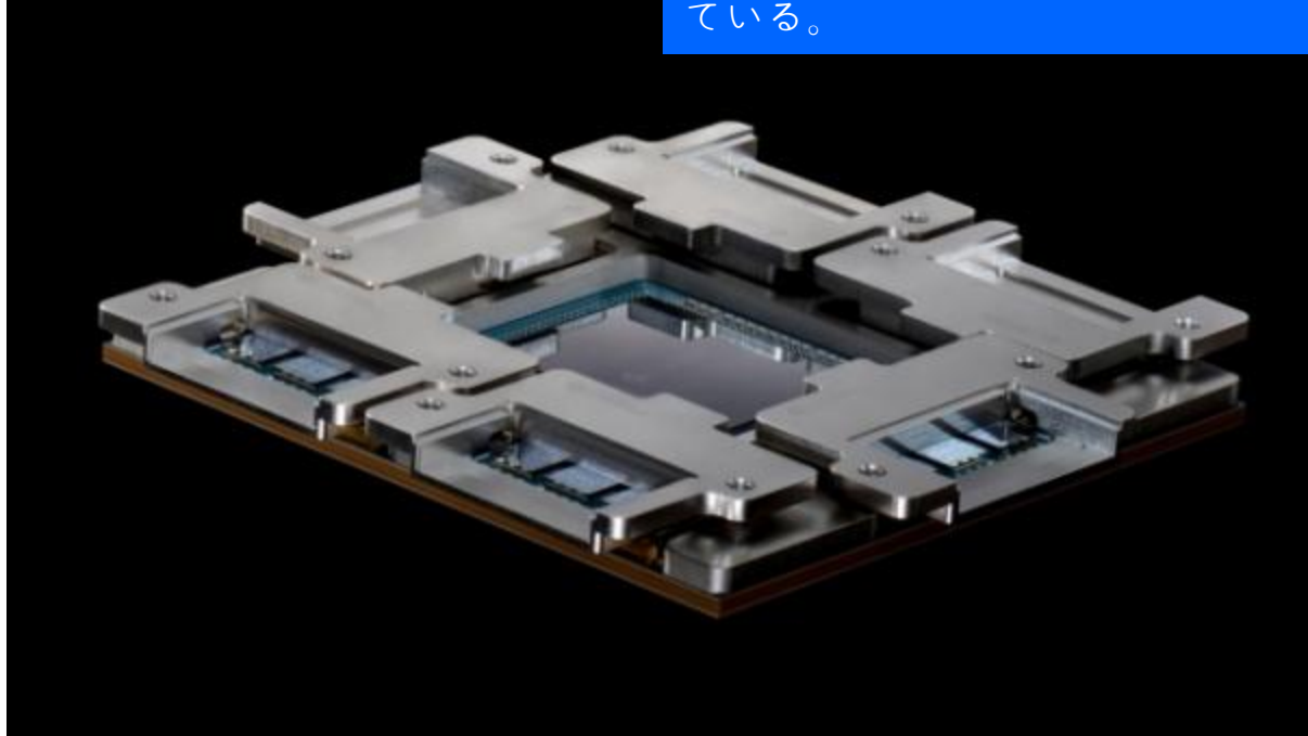
NVIDIA Quantum-X フォトニクス: NVIDIA Quantum-X800 InfiniBand プラットフォーム向けの 200G ベースのCo-Packaged Optics
